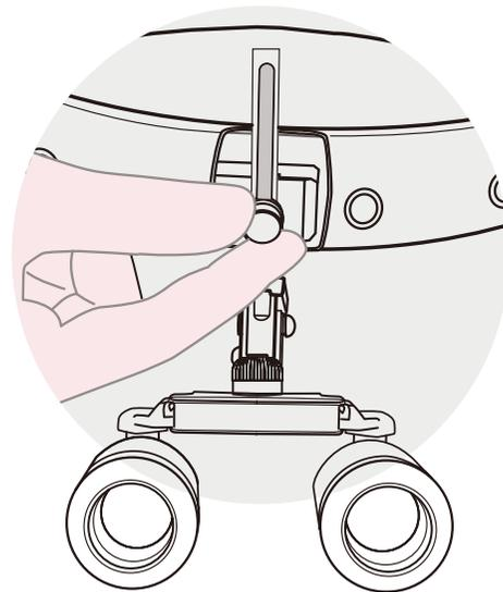
ルーペの高さ調節が完了したら、ネジを最後まで締めて高さを固定します。
