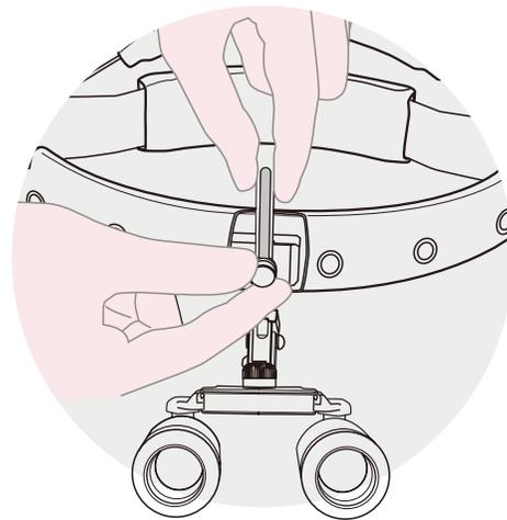
ヘッドマウントのフロント凹部にルーペのバー部分を取り付け、ネジで固定します。高さを調節 (P10参照) するときにはバーの位置を変更するので、このネジは少し緩めた状態にしてください。
