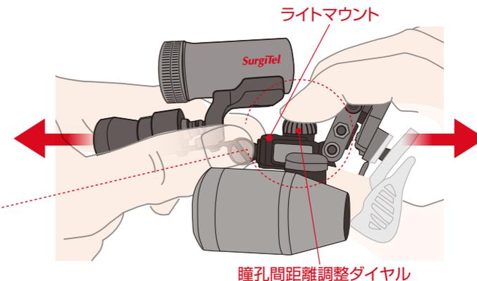
※ ライトマウントを図のように持ち、瞳孔間距離調整ダイヤル
